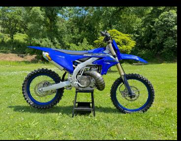
TECHNICAL DATA WEIGHT: 106,5kg WEIGHT FRONT: 55 kg WIEGHT REAR: 51,5 kg HP: 60
